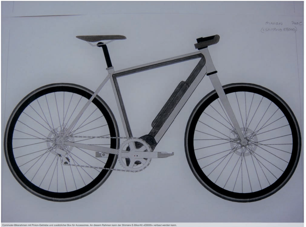
Commuter-Bikerahmen mit Pinion-Getriebe und zusätzlicher Box für Accessoires. An diesem Rahmen kann der Shimano E-Bike-Kit »E8000« verbaut werden kann.
