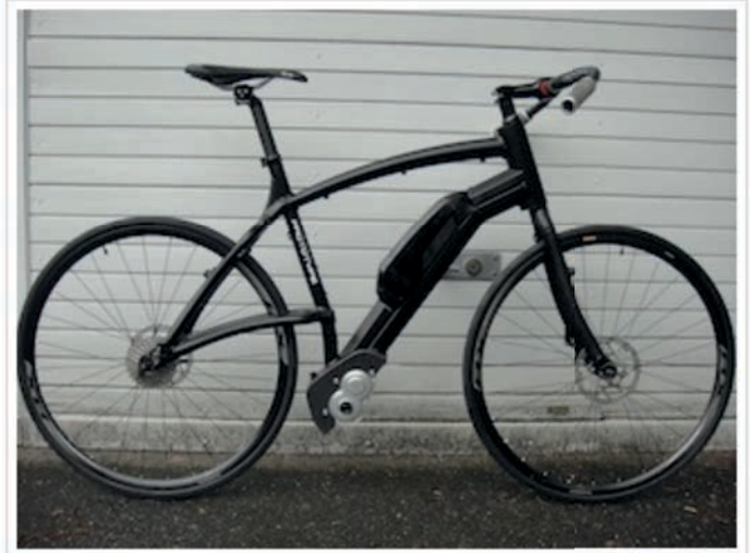
Fahrradrahmen-Prototype mit Pinion-Gearbox
